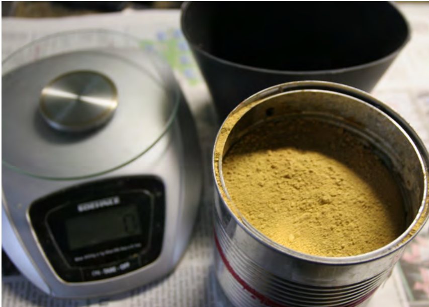
Foto 1 bis 3: Anrühren des Lehmpulvers für den Kastenboden
